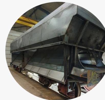
Réalisation d'ensembles mécano-soudés dans le domaine du ferroviaire
