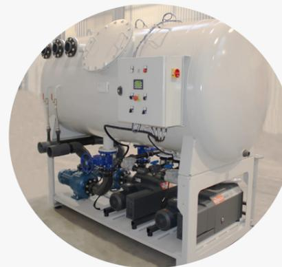
Fabrication de cuves, montées intégralement dans nos ateliers, pour un système d'évacuation sous vide
